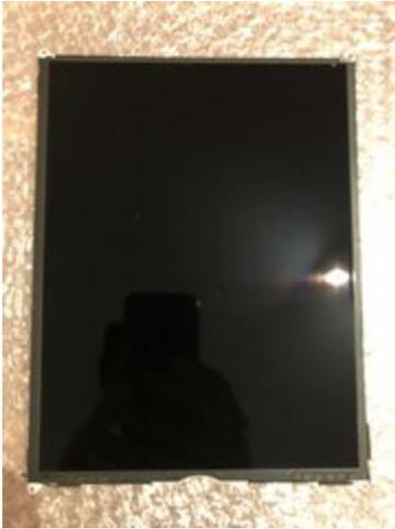
Das LCD Panel hätte ich so oder so ausbauen müssen, da sich das Logic Board darunter befindet von dem ich noch das Home Button & Touch Sensor Kabel entfernen musste.
