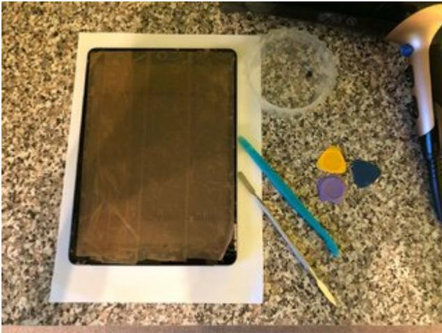
Jetzt ringsum die Scheibe mit einem Fön erhitzen um den Kleber an zu lösen & mit dem Spatel Stück für Stück die Glasscheibe vom Gehäuse entfernen.
