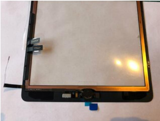
Das neue LCD & Glas am Board wieder angeschlossen.
