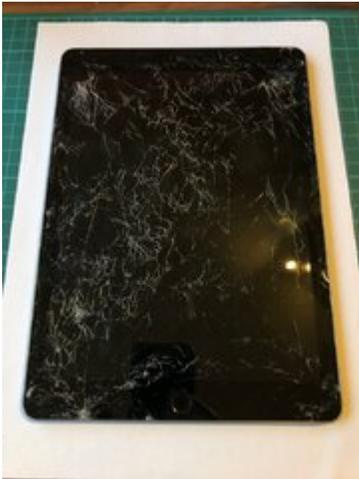
Anders als bei iPhones sind bei einigen iPad Modellen Glasscheibe, TouchSensor & LCD Panel nicht mit einander verklebt, sondern separate Bauteile.
