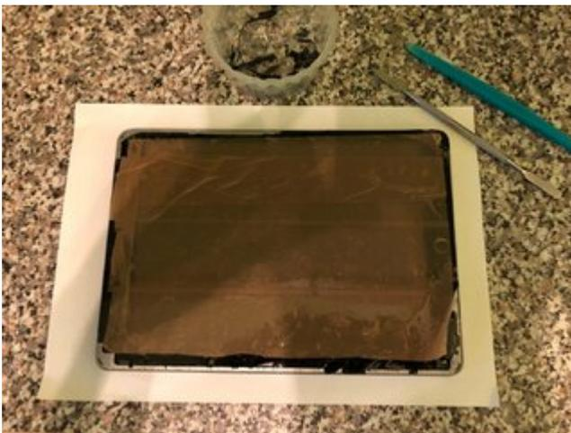
Das Glas ist ab, hängt aber noch mit den Kabeln vom Touchsensor & Home Button am Logicboard. Als nächstes muss das LCD Panel raus um an das Logic Board & an die Stecker der Kabel drann zu kommen.
