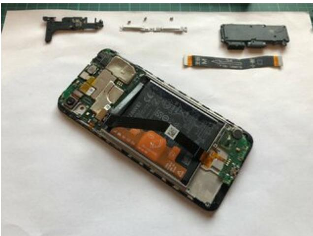
Bis auf den Akku sind alle Komponenten ausgebaut. Den Akku ab ich bis zum Schluss aufgehoben, den der Kleber muss wieder mit einem Föhn erhitzt werden.
