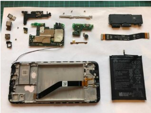
Jetzt wird wieder alles rückwärts in den neuen Rahmen eingebaut. Hier sind die beiden Platinen. Der Ohrhörer & Vibrationsmotor & Seitentasten wieder an ihrem Platz.
