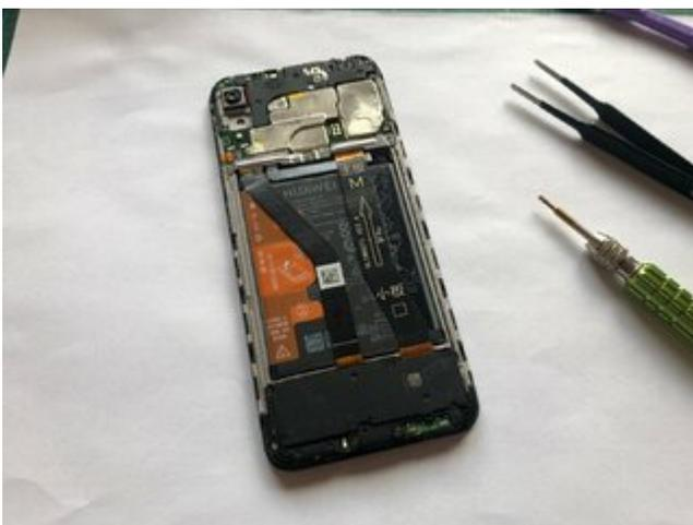
Nun kurz das neue Display zum testen angeschlossen.
