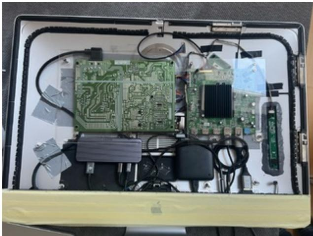
Für das Netzteil und Board hab ich 1mm starke Acrylplatten verwendet um die Originalsockel im iMac zu nutzen. Das ist jetzt fest an 5 originalen Sockeln und zwei die ich rausgerissen und
