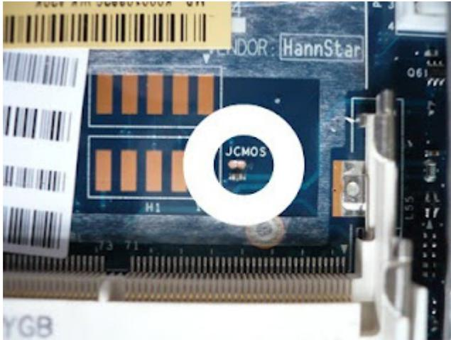
6. Wenn gefunden diese beiden Kontakte kurz mit einer Büroklammer oder einem Stück Draht brücken (2-5 Sek.)
