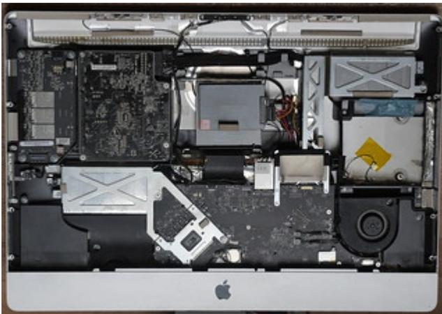
Einige Schrauben und etliche Kabel müssen entfernt werden damit das Logicboard (Mainboard) herausgenommen werden kann.
