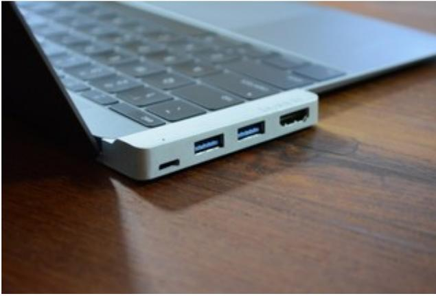
Kurz beschrieben stellt Branch dem 12-Zoll MacBook-Besitzer einen USB Type-C Port, zwei USB 3.0 Ports und einen HDMI-Anschluss zur Verfügung. Durch den Hub können also problemlos weitere USB-Geräte angesteckt werden, auch wenn das MacBook über den USB-C-Anschluss gerade mit Strom versorgt wird. Ein praktischer Mini-LED-Indikator signalisiert dem Anwender, dass das MacBook gerade geladen wird und macht diesem deutlich sobald der Akku voll ist.
