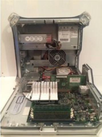
Zunächste alle Kabel lösen, RAM raus, CPU-Kühler entfernen (ja, da ist wirklich keine Wärmeleitpaste zwischen CPU und Kühlkörper), Steckkarten wie Grafikkarte, USB-Karte u.ä. ausbauen:
