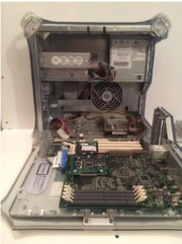
Im nächsten Schritt wird nun das Mainboard entfernt. Dabei kommt uns zu Gute, das es mit nur 3 Schrauben gehalten wird - diese lösen, das Board nach rechts schieben, links anheben und herausnehmen.
