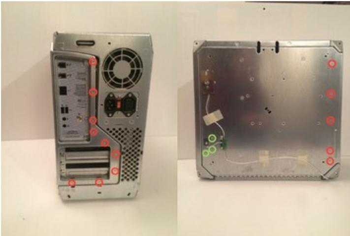
Blende für I/O-Shield und PCI-Slot befestigen.
