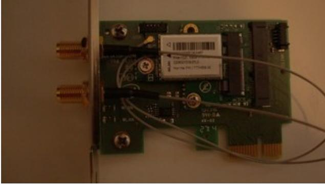
Das ist eine PCIe Karte mit einem mPCI Stekplatz drauf. An dem ist ein mPCI zu M.2 Adapter aufgesteckt, auf dem wiederum eine halb breite M.2 Karte gesteckt wurde. Der mPCI zu M.2 Adapter ist so groß wie eine normale mPCI Karte, das sollte dir gut den Größenunterschied verdeutlichen.
