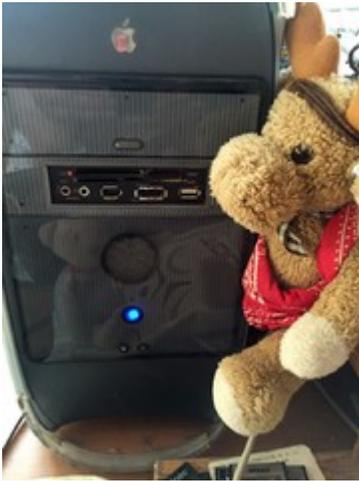
Blink-Lampe, Sllot-in-Laufwerk und SSD-Fach hinter der Klappe, Card-Reader und Stecker-Panel, Lautsprecher, Hauptschalter mit LED und Reset-Schalter sind das von Oben nach Unten..
