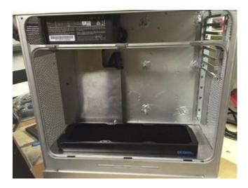
Das Netzteil ist nach oben links gewandert, die aufsteigende Abwärme soll über den 140mm Lüfter gleich raus und nach vorne raus transportiert werden. Unkonventionell - aber bei dem sehr guten bequied Netzteil erwarte ich keine Pfiep- oder Lüftergeräusche.
