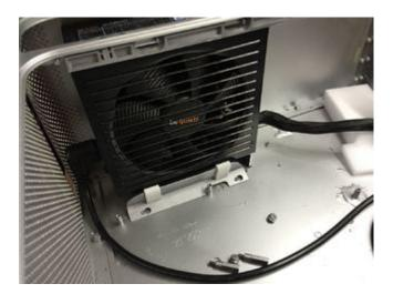
Das in 40mm Abstand angebrachte Deckblech dient für das Verstauen von Kabeln und - was viel wichtiger ist - auch als Luftabfuhrkanal der Warmluft nach vorne raus. Die Abluftfläche entspricht etwa die von 2x120 Radiatoren.
