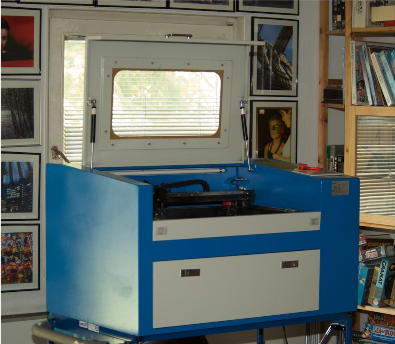
50W, Ethernet, Elektrisch verstellbarer Tisch, Strahlstärke per Software einstellbar, Wassersensor.
