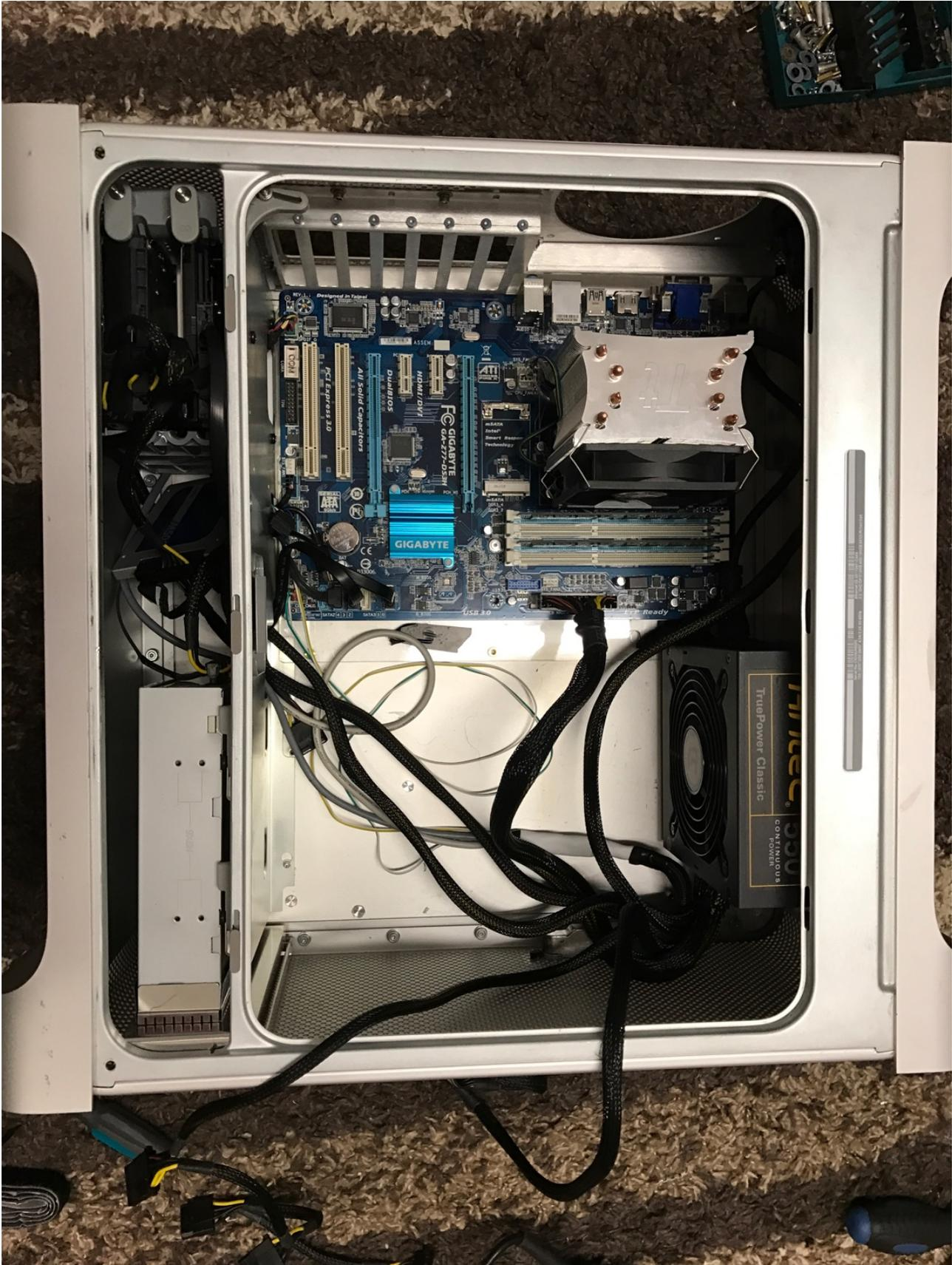
Der Kabelbaum wird angepasst:
