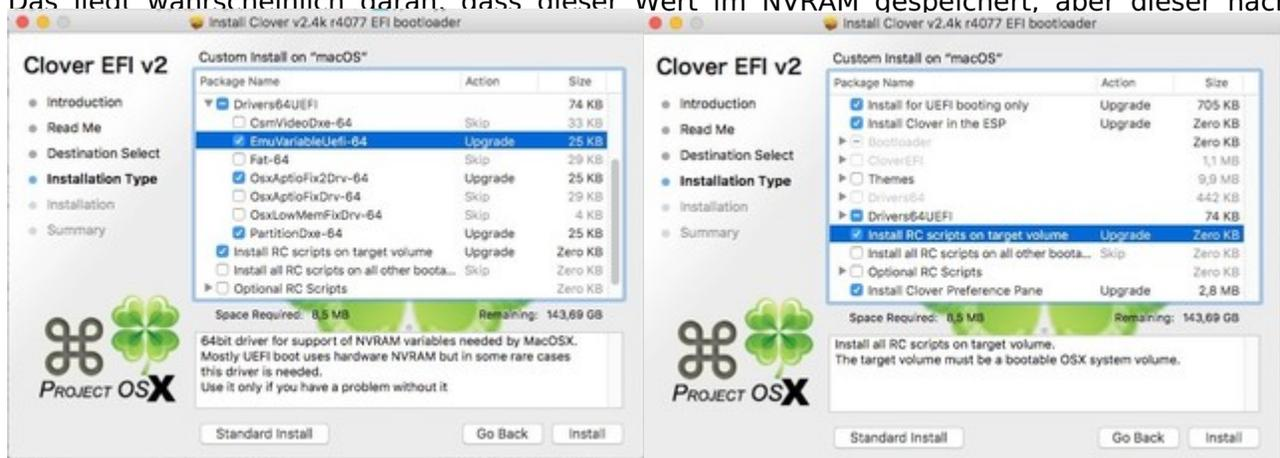
Einmal muss der EFI-Treiber EmuVariableUefi-64.efi aktiviert und zum anderen die RC-Skripte auf der Ziel-HDD/SSD vorhanden sein.
