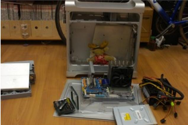
Im MacPro-Gehäuse hat er die langen Bolzen in der Fläche rausgebrochen und die Innenrückwand aus England eingeschraubt, die da ganz prima und passgenau rein ging. Ein wirkliches Meisterstück, dieses Teil! Leider fehlt diesem exzellenten Bausatz eine Säge-Maske für die Gehäuse-Seite mit den Anschlüssen (und das Lüfter-Loch ist ca.2,5 mm zu klein für den Original-Lüfter-Grill), dann wäre er perfekt!
