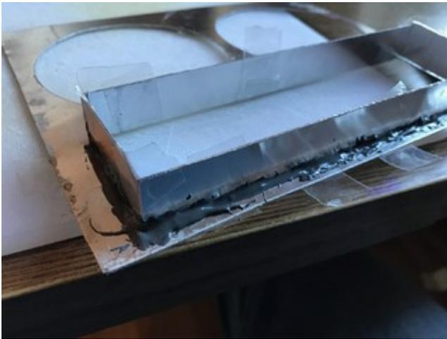
Gehäuse steht hier gerade auf dem Kopf, baue die Festplatten mit selbstgebauten Haltern ein
