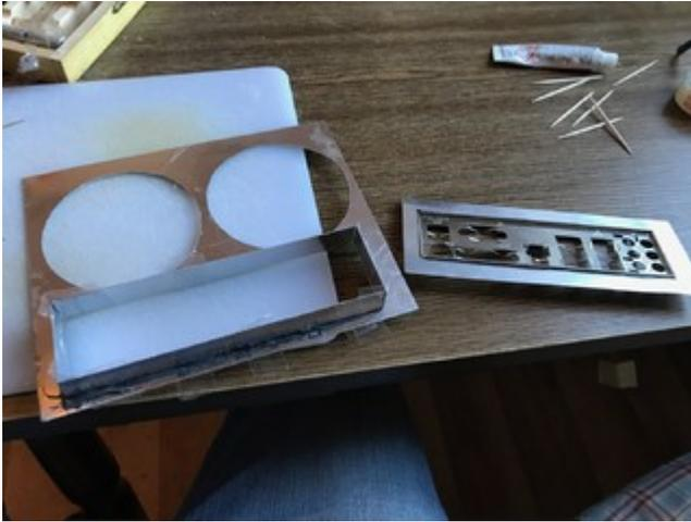
Rückblende mit JB-Weld zusammengeklebt
