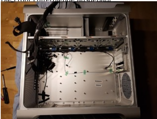
Der erste Blick ins noch volle Gehäuse. Die Halterung für die Speicherslots wurde ausgebaut. Die Front Lüfterblende ausgebaut
