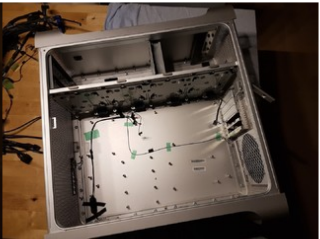
Der erste Blick ins noch volle Gehäuse. Die Halterung für die Speicherslots wurde ausgebaut. Die Front Lüfterblende ausgebaut
