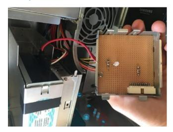
Die Frontplatine mit der alten Elektronik habe ich rausgeschmissen. Allerdings habe ich mir vorher die zweifarbige LED sowie den Anschluss fürs Flachband-Kabel ausgelötet und auf die neue Platine übernommen. Auch das alte Flachband-Kabel selbst habe ich wieder eingebaut. Den Stecker per Dremel etwas schmäler machen, und schon passt er in die neue Hauptplatine ...
