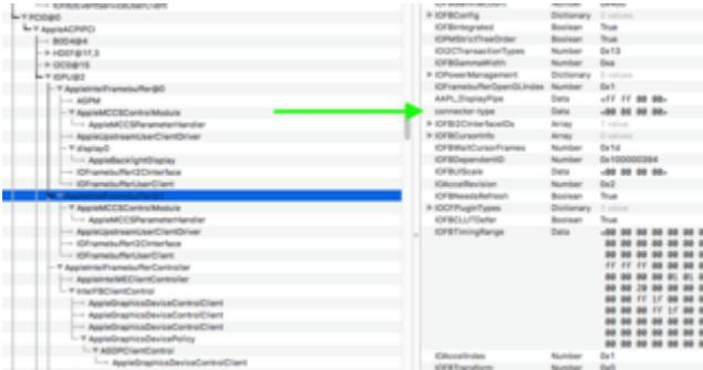
AppleIntelFramebuffer@1 = HDMI-Ausgang. Hier ist allerdings kein Display angeschlossen, sonst würde das als display0 auftauchen. Ist auch schon umgepatcht von DP auf HDMI (connector-type <00 08 00 00>):
