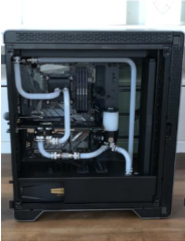
Pumpe an einen freien 4 Pin with Pump Anschluss damit du die Pumpe per PWM einzeln ansteuern kannst im Bios.
