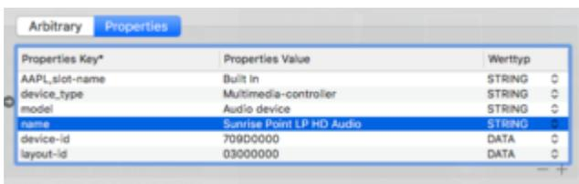
Mit der layout-id und der Spalte Properties Value als Data, hat man nun auch Effekt das AppleAlc greift und den Ton ausgibt.
