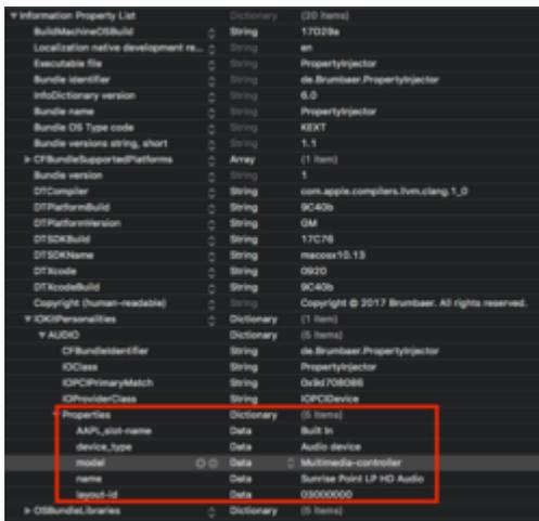
Mit der `layout-id` und der Zeile Properties als Data, hat man nun auch Effekt das AppleAlc greift und den Ton ausgibt.
