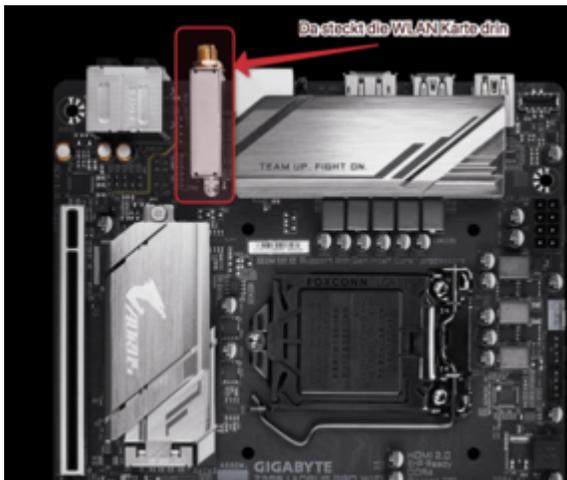
Die verbaute Intelkarte muß du da entnehmen und eine passende für macOS Kompatible Karte einbauen
