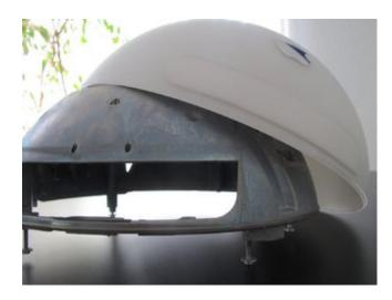
Übrig bleibt eine ziemlich leichte Basisplatte mit einem umlaufenden weiß gefärbten Ring aus Kunststoff und eben jene "weisse Mütze", die absolut perfekt in die Sicke des erwähnten umlaufenden Rings der Bodenplatte "einrastet" und die Form prägt.
