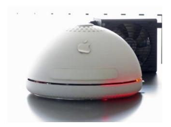
Der Deckel (wiegt nur ca. 100 Gramm) liegt nur auf und kann mit einem Handgriff abgenommen werden. Schneller kommt man nicht an die Hardware. Und wenn man diesen ganzen RGB-Trend ausleben will, sieht hier sogar eine umlaufende Leiste im Bereich des Spalts ganz cool aus.
