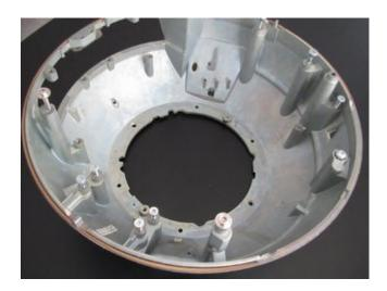
Gefühlt 50 Maschinengewinde wurden geschnitten – darunter zahlreiche Sacklöcher – und wenn man genau hinschaut, erkennt man auch einige verpresste Zapfen aus hochwertiger Legierung.
