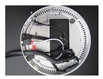
Die Stromversorgung ist eine ziemliche Fummelei und das ging in meinem Fall auch nur, weil am Netzteil (Corsair RM650x) der 24-polige Stecker in zwei Blöcke (1x 10fach-Stecker und 1x
