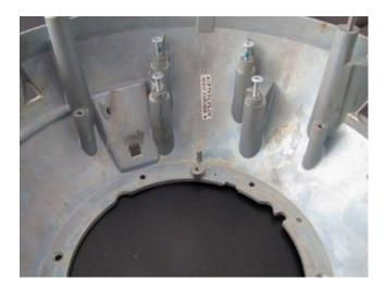
Der Gusskörper sorgte mit rund fünf Kilogramm nicht nur für das notwendige Gewicht der Basis – er nahm auch die Abwärme der CPU während eines langen Arbeitstages auf und gab sie in der Ruhepause langsam wieder ab. Für einen 24/7 Betrieb war die minimalistische Kühlung des iMac allerdings nicht ausgelegt – und daran hat sich auch heute nichts verändert.
