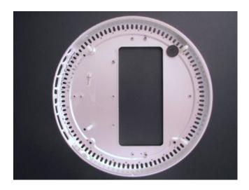
Der schwarze runde Puffer rechts oben deckt ein Loch ab, das ich durch ungeschicktes Hantieren mit der Handbohrmaschine in der Grundplatte verursacht habe. Danach habe ich mir einen Ständer für die Handbohrmaschine besorgt, mit dem ich die weiteren Löcher präzise und ohne "Wanderung" des Bohrers gemacht habe. Merke: Schlechtes Werkzeug = schlechtes Ergebnis.
