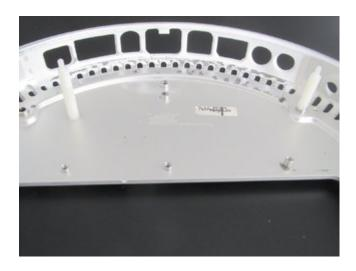
Wenn man genau hinschaut, lässt sich durch Kombination unterschiedlicher Längen der Abstandshalter die Montagelage (Höhe) des Mainboards innerhalb des Gehäuses sehr fein justieren. Da sich einige Befestigungspunkte bereits am (leicht erhöhten) Rand der Bodenplatte befinden (das lässt sich leider nicht vermeiden, wenn man den Zugang zur NVMe von unten erhalten will), ist ein Höhenausgleich durch unterschiedliche Längen der Zapfen unvermeidbar.
