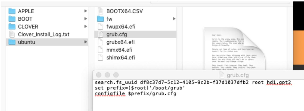
das wär ein dualboot-ordner vom T440s (vorm urlaub) -> xubuntu auf der 2.ssd, das ist der verweis root hd1,gpt2 (2. platte, rootfilesystem auf der 2. partition). die lange uuid ist die uuid von sdb2 - das rootfilesystem. \$prefix ist eine variable, die auf die ausführliche grub.config in /boot/grub/grub.cfg (in der 2. partition, sdb2) zeigt. (die lass ich hier mal aussen vor, die ist elend lang) du müsstest beide anpassen..(\*grmpff\*)
