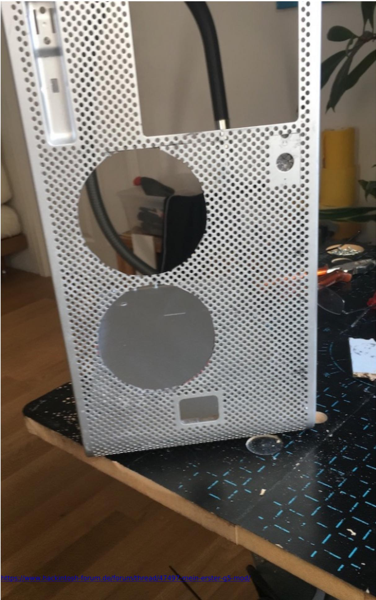
Dieser wird mit einer angefertigten 0,8mm Alu Platte von innen verklebt.
