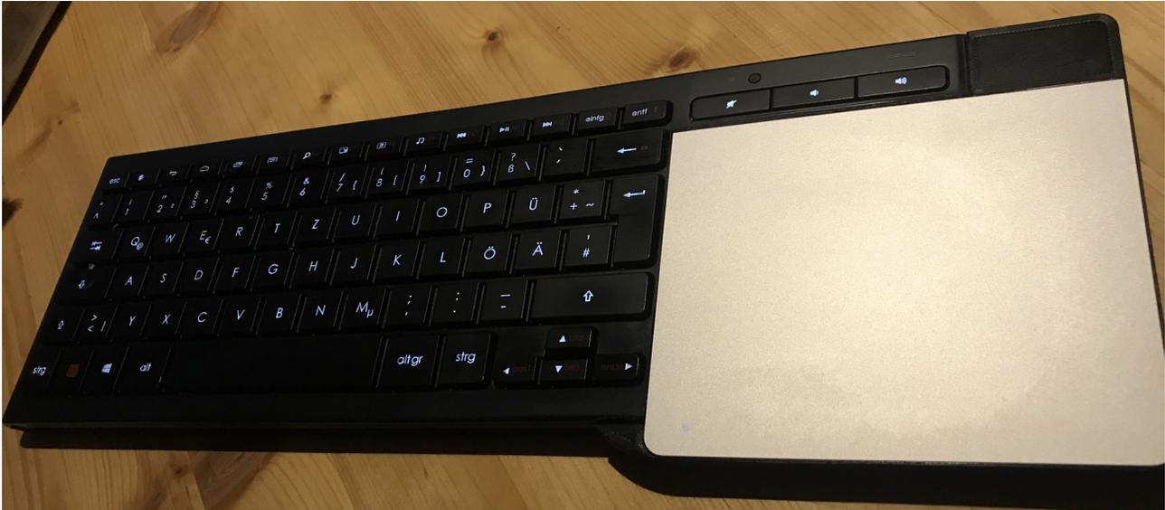
Das ist eine Standard K830 Tastatur mit eingebautem Apple Magic Trackpad 1.
