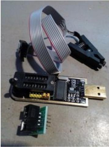
zange (oben), den programmer (CH341A heisst das gute stück) und ein platinchen, um die beiden teile zusammenzufügen.
