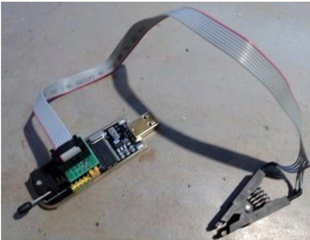
die zange kommt (richtig herum, auf die markierungen an der zange und am bioschip achten!!) auf den bioschip, der programmer wird an den 2. rechner gesteckt. dann das tool aufrufen, bios auslesen, speichern, und danach die neue biosdatei auf den chip schreiben.
