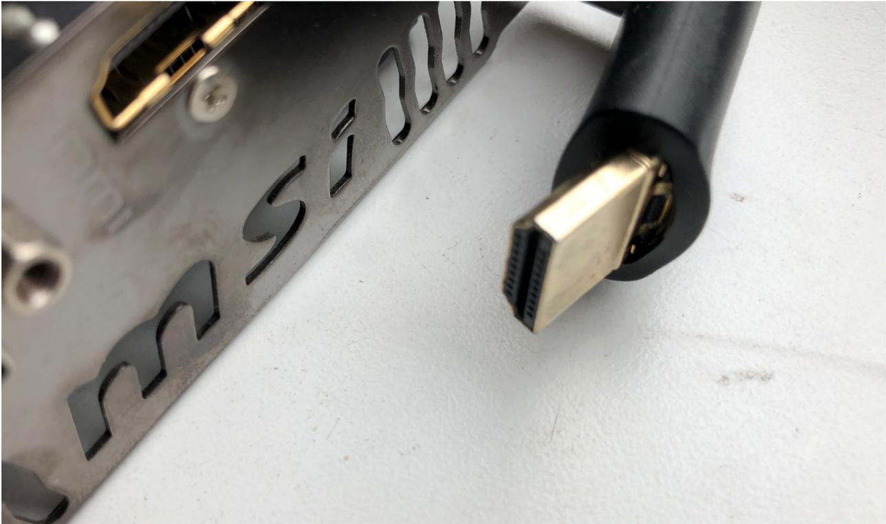
Der Stecker des HDMI-Kabels ist ordentlich verbogen. Und der oft nervende weil unter großen Grafikkarten kaum zu erreichende Sicherungshebel am PCI-e-Slot ist abgebrochen.
