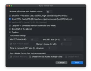
Am besten erstmal die AVX-Optionen deaktivieren. Wenn sich die Temperaturen kaum noch nach oben bewegen, Neustart und im BIOS die Spannung weitere 0.01V runter setzen und so weiter. GGf. musst die Loadline-Optionen noch etwas anpassen, je nach Board lauten auch die auswählbaren Werte unterschiedlich.
