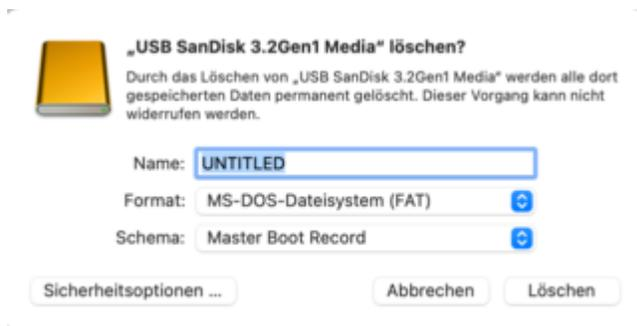
Wichtig ist das Du unter Schema Master Boot Record auswählst und als Format halt FAT. Auf diesen so erstellten Stick ziehst Du dann den Ordner EFI in dem sich dann die Ordner /boot und /OC befinden (wenn OpenCore der Bootloader sein soll). So ausgestattet startet der Rechner dann auch von dem Stick.
