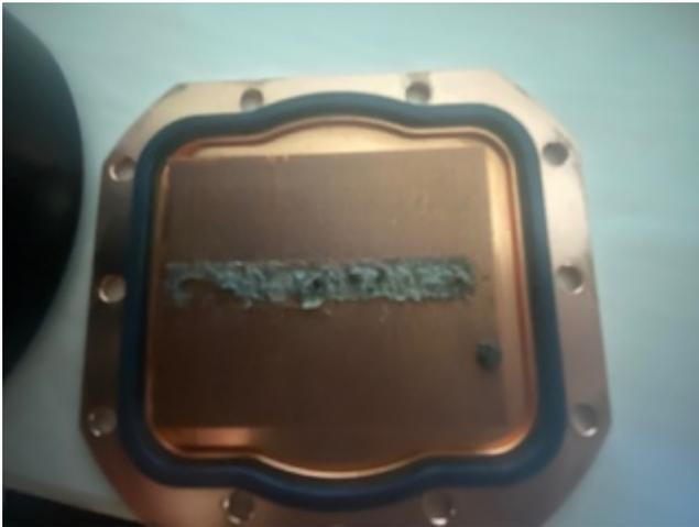
Eine "Schlamm Masse" genau in dem Bereich, in dem das gekühlte Wasser durch die Lamellen gedrückt werden sollte, um für die benötigte Wärmeabfuhr zu sorgen.
