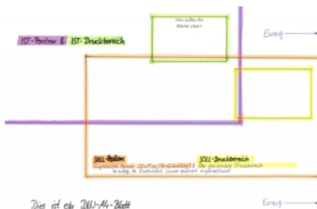
Eigentlich sollte der Druckbereich wie orange markiert mittig und an der Einzugskante liegen. Er ist aber wie zu sehen komplett versetzt und das bemessen am Format A4.
