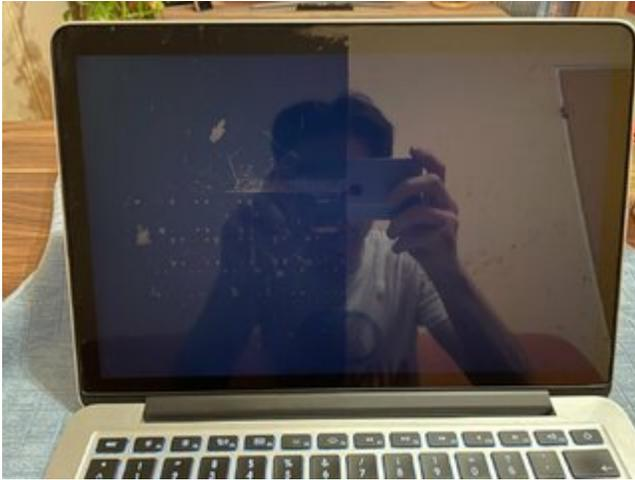
Wie man hier sieht ist im eingeschalteten Zustand praktisch kein Unterschied vom Bild zwischen den beiden Display Hälften zu sehen. Das einzige neben dem leicht entspiegelnden Effekt der Beschichtung, mit wirkt das Schwarz etwas kräftiger als ohne.
