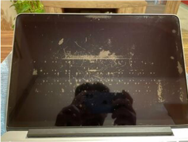
Ich habe das Display zur Hälfte abgeklebt um den Vorher/Nachher Effekt gut zeigen zu können. Das Zwischenergebnis nach 10 Minuten bearbeiten mit Iso & einem Mikrofasertuch. Was dabei auffällt, die Beschichtung ist im unteren Bereich hartnäckiger & geht schwerer ab als Oben.
