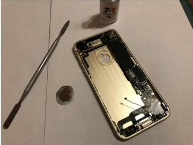
Und das neue Logo einsetzen. Wie hier zu sehen hab ich das Logo noch rings um mit B-7000 Kleber abgedichtet. Damit das Gehäuse auch weiterhin wasserdicht ist.
