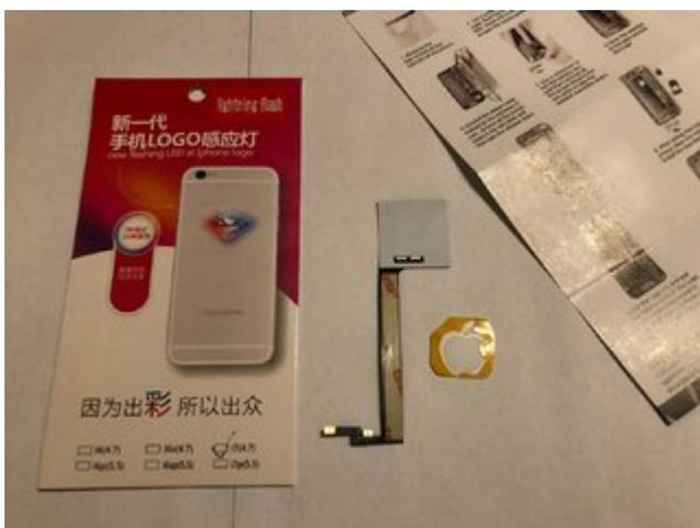
Das ist das Flex Kabel mit den RGB-LEDs für die Lautsprecheröffnungen.
