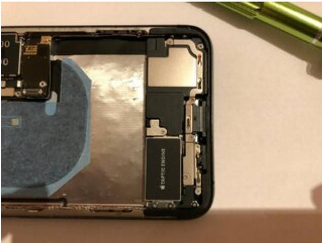
Als nächsten kann der Akku wieder eingebaut werden & nach einem kurzen Funktionstest kann dann auf die Display Dichtung eingeklebt werden.
