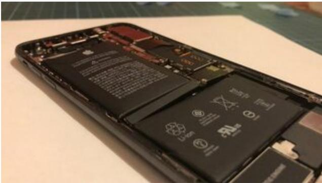
Also musste der Akku raus. Vorteil, so hab ich mehr Platz das innere Blech wieder gerade zu biegen das sich beim Aufprall auf die Wand auch verbogen hat. Dazu mussten TapticEngine & Lautsprecher ausgebaut werden. Als ich diese ausgebaut hatte zeigte sich, zusätzlich ist noch eins der zwei Flexkabel unter dem Lautsprecher auch gerissen. Also neuen Akku & Flexkabel nach bestellt.
