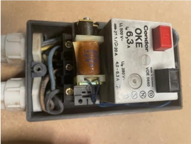
Die Magnetspule wird zwischen zwei Phasen geschaltet und hat 380V.
